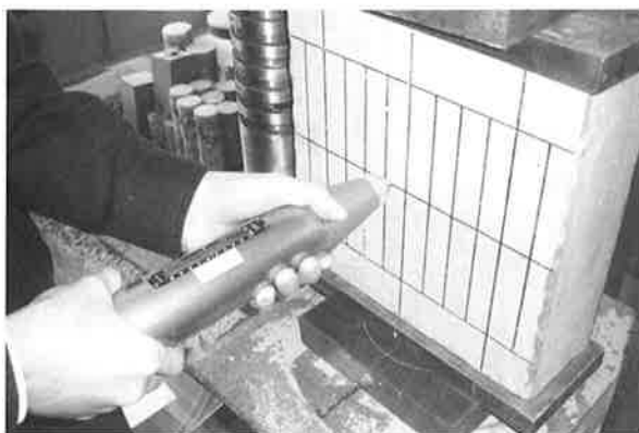
コンクリート反発度測定試験
